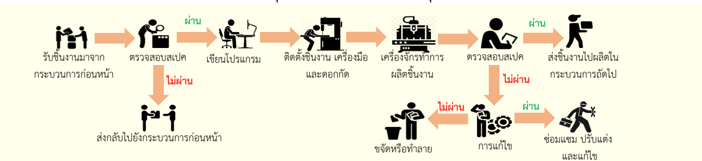
ภาพ 1 ขั้นตอนการทำงานของกระบวนการกีดชิ้นงานโลหะโดยเครื่องกัดซีเอ็นซี
